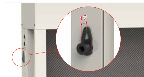
Guida con compensatore completo di regoli: i regoli o registri di regolazione posizionati nelle guide laterali garantiscono l'installazione in vani fuori squadra o in presenza di superfici irregolari e non omogenee. Regolo di compensazione fino a 10 mm .
