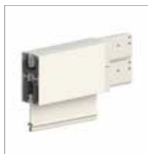
Terminale 35x70 mm con profilo telescopico da 30 mm e guarnizione da 5 mm (senza sovrapprezzo).
