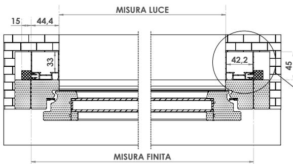
ABILITAZIONE DELLA PREDISPOSIZIONE PER L'INCASSO DEL MODELLO WIND 42 DOPO ROTAZIONE DI 90° DEL PROFILO
