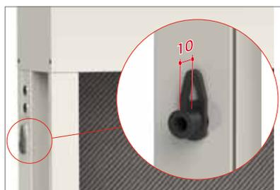
■ Guida con compensatore completo di regoli: **i regoli o registri di regolazione** posizionati nelle guide laterali garantiscono l'installazione in vani fuori squadra o in presenza di superfici irregolari e non omogenee. Regolo di compensazione **fino a 10 mm**.
