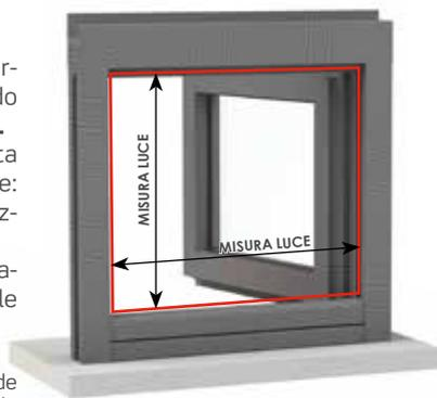
Modello **PRATIK UP**: formulare l'ordine indicando sempre la **misura LUCE** \*. La zanzariera verrà fornita con misure maggiorate: larghezza + 22 mm, altezza + 20 mm.
