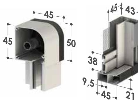
Prodotto ideale per l'installazione in spazi ridotti: il cassonetto e le guide costituiscono un telaio che si applica frontalmente al vano grazie alle clips di fissaggio.
